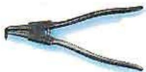
: Plier, circlip, 90 deg
